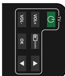
TV yazısı ve beyaz çerçeve ile ayrılmış olan içindeki diğer tuşları da (yandaki tuşlar) yukarıda anlatıldığı gibi televizyon kumandası ile aynı şekilde programlayın.
